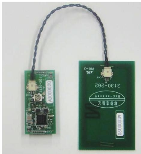
「UF-S957S(WS)」は、ISO18092 NFC IP-1、ISO14443 Type-A/Type-B規格に対応した組込用リーダ／ライタモジュールです
